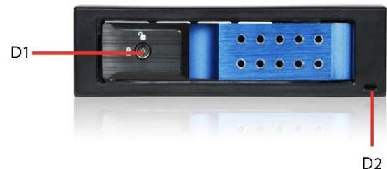
D-1: Замок безопасности. Закрытие гарантирует надежную фиксацию жесткого диска и контроль доступа к жесткому диску.
