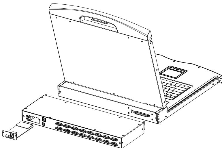
1. Отсек для установки расположен на задней стенке КВМ консоли. Для установки требуется отвертка с крестообразным шлицем.
