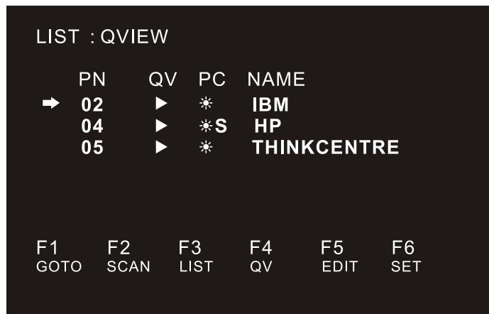
Данная функция позволяет выбрать порт для быстрого просмотра. Выберите порт и нажмите клавишу [F4], появится иконка в виде треугольника. Чтобы снять выделение, нажмите еще раз клавишу [F4].
