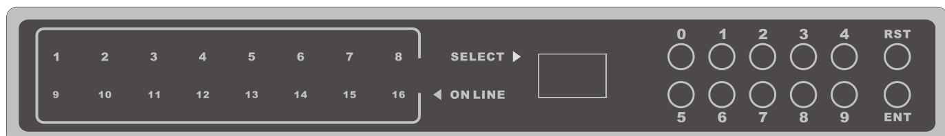
Кнопки выбора портов расположены сверху от клавиатуры и разделены на три блока, слева на право – индикация подключенных портов, индикация выбранного порта, цифровые клавиши, клавиша сброс [RST] и клавиша выбора порта ENT.
