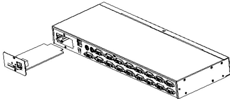
4. Вставьте модуль в слот и зафиксируйте винтами, которыми была закреплена защитная планка.
